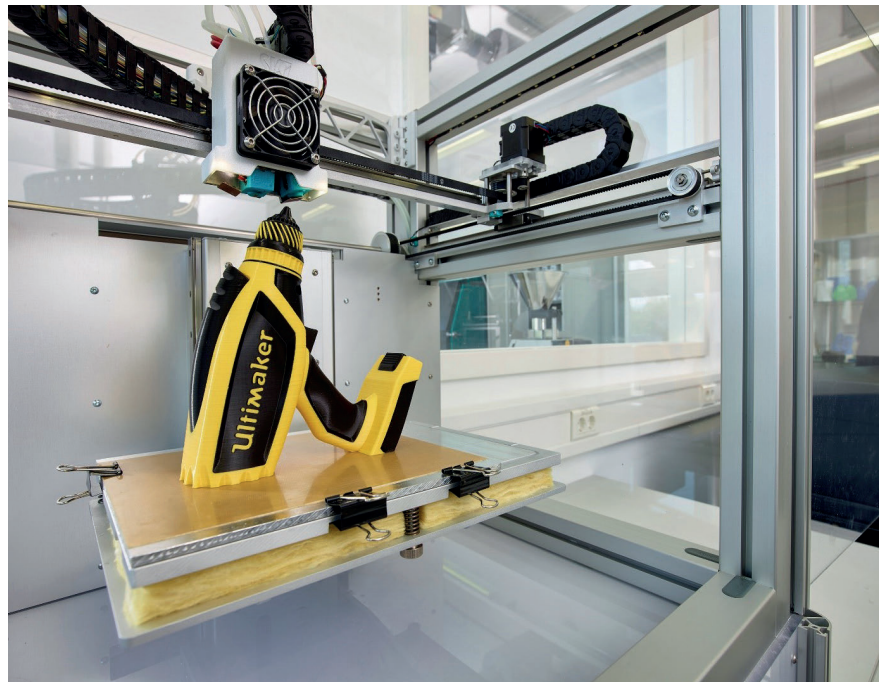
Blick in den Bauraum eines FLM-Druckers: Mithilfe von Strömungssimulationen soll der 3D-Druckprozess besser verstanden und vorhergesagt werden © SKZ
